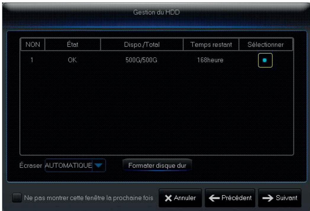
Pour s'assurer du bon fonctionnement du disque dur, allez dans l'onglet Appareil, et cochez Sélectionner « Sélectionner » puis cliquez sur « Formater disque dur ».
